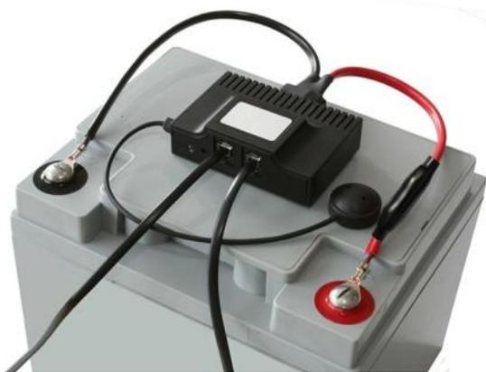
**Kennzeichen:** patentiertes Equalizing, Einzelblockspannungsregelung, Surgeprotector-Kabel, LED-Status für Fehleranzeige und Buskabelanschlüssen, Zustandsprotokollierung und Fehlerauswertung von jeder einzelnen Batterie über einen Web-Browser.
