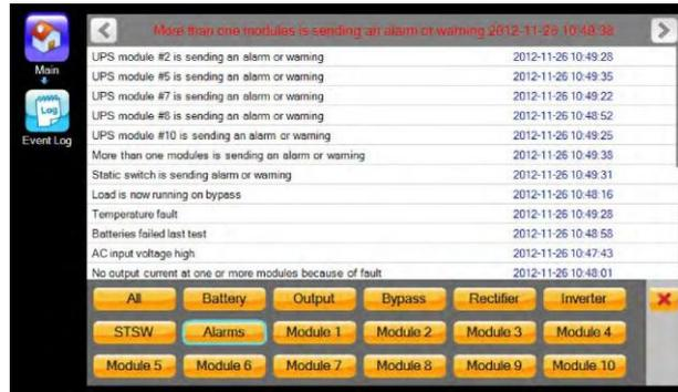
Abb. 46: Anzeige „Alarms“ aus dem Bildschirm „Log-Details“
