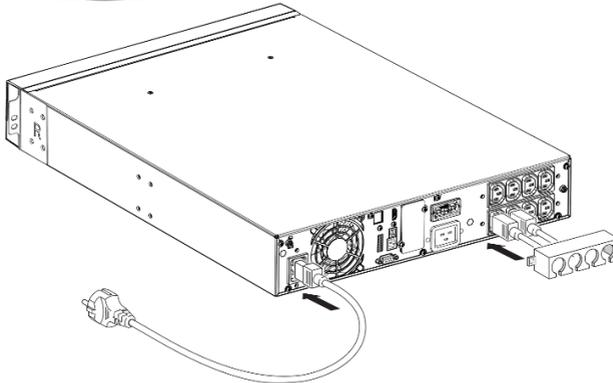
Hinweis: Die USV lädt die Batterie, sobald sie an die Wechselstromquelle angeschlossen wird, auch wenn die Taste nicht gedrückt wird.
